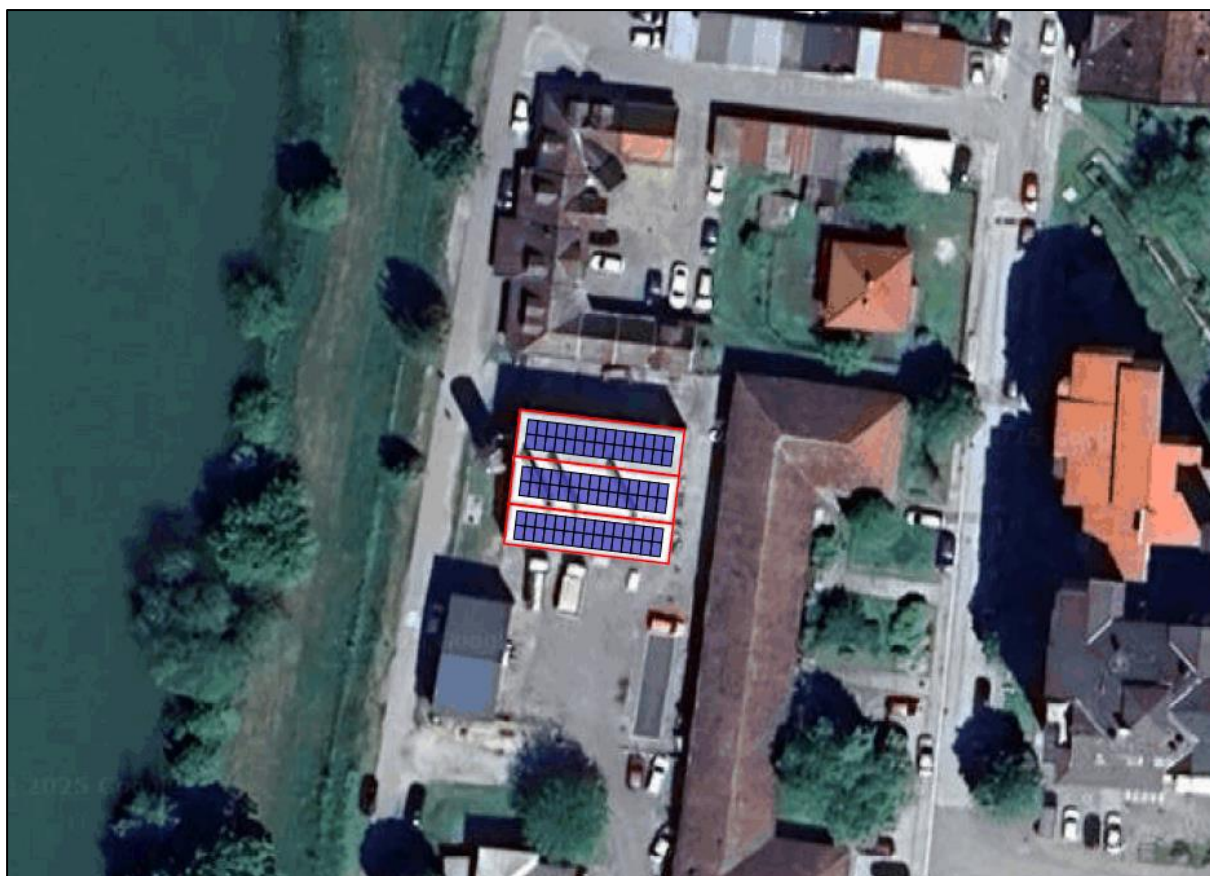
Sl. 3-20 Raspored fotonaponskih panela, Toplana na biomasu, Mali Zvornik (Izvor: Base K2)
