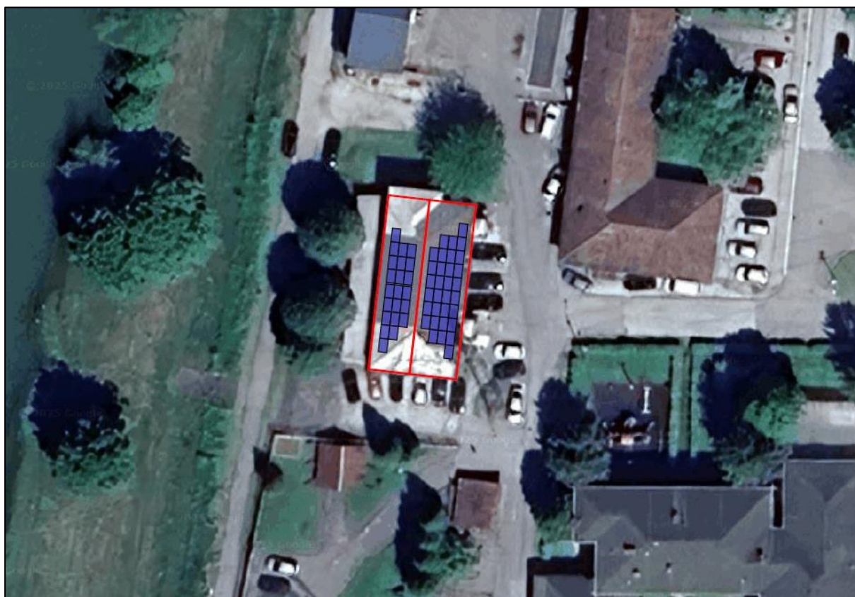
Sl. 3-11 Raspored fotonaponskih panela, Upravna zgrada - Javno komunalno poduzeće „Drina“ (Izvor: Base K2)
