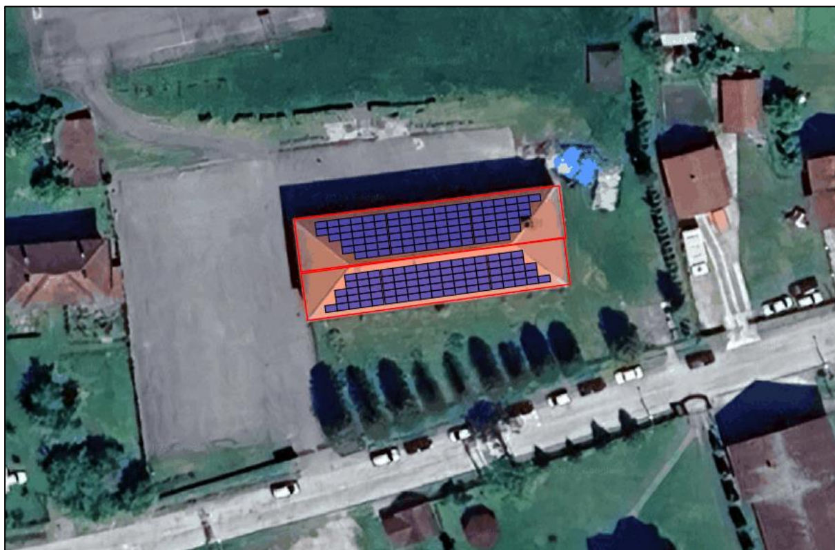
Sl. 3-84 Raspored fotonaponskih panela, Osnovna škola „Stevan Filipović“ Radalj, (Izvor: Base K2)
