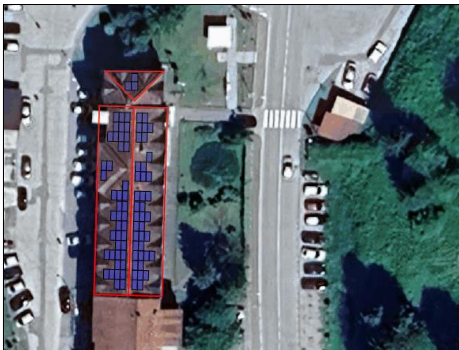
Sl. 3-4 Raspored fotonaponskih panela, Zgrada opštinske uprav, Mali Zvornik, (Izvor: Base K2)
